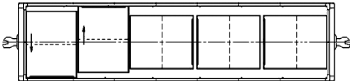
3. ábra - A konténer elrendezése 12324 mm belső szekrényhosszúságú, magas oldalfalú teherkocsiban és konténerszállító kocsiban
