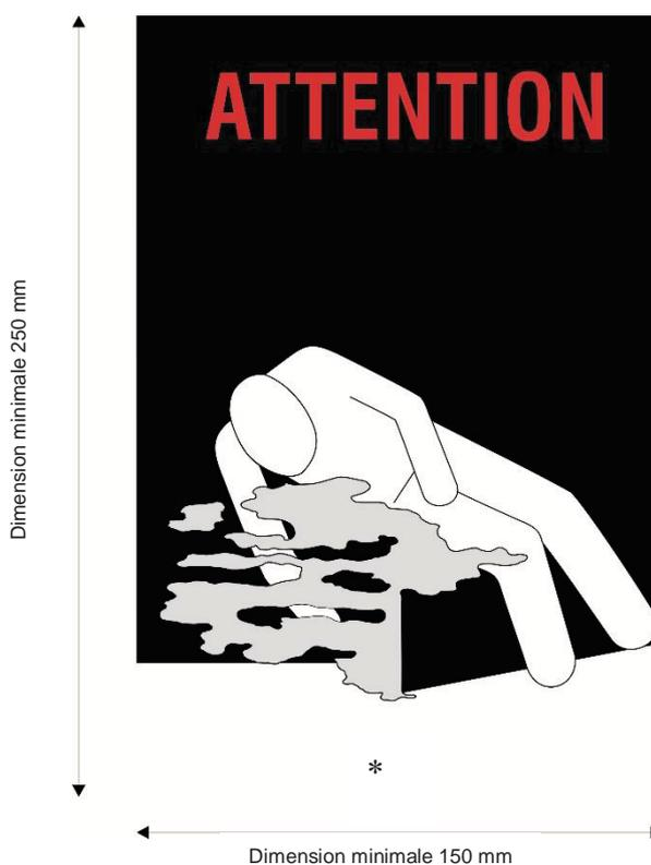
Marque de mise en garde contre l'asphyxie pour les véhicules, wagons et conteneurs
