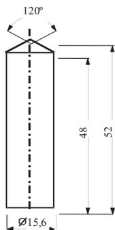
Fig.2: Piston cylindrique en bronze, dimensions en mm
